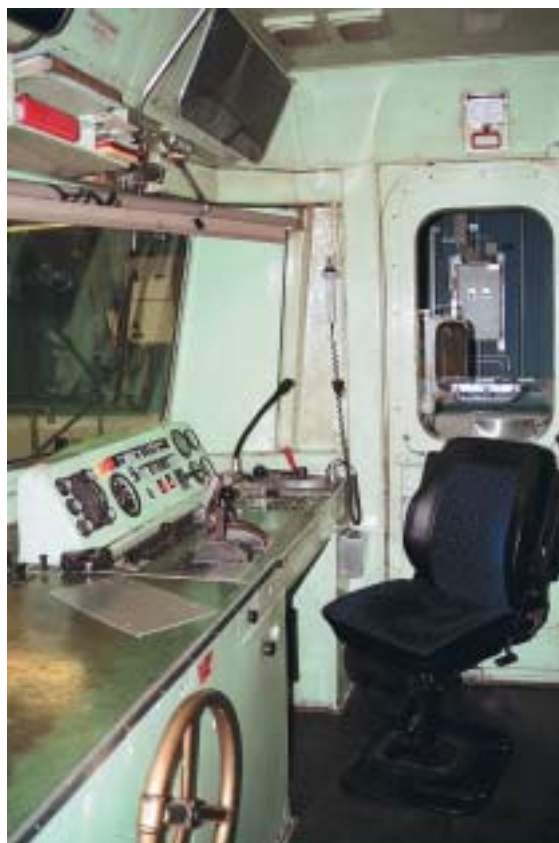
Förarplatsen i den första 420-motorvagnen efter montering av bland annat svensk ATC. Foto Johan Hellström.
